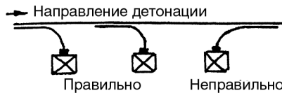
Рис. 3.9. Расположение сростков в сетях ДШ в зависимости от направления детонации
